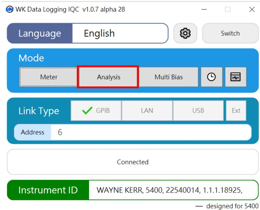
圖 31 電腦跟 5400 連接好 GPIB 後，選擇 Analysis Mode
