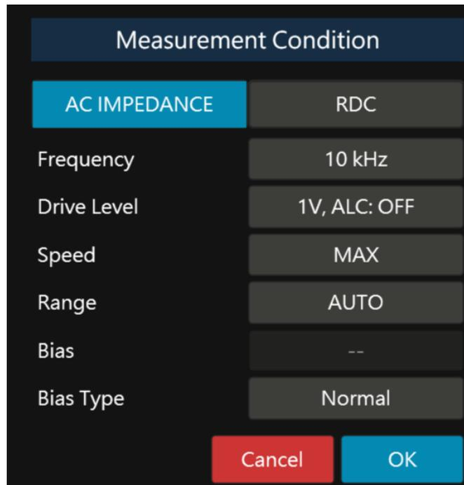
圖 11 可以更改的測試環境有 Frequency/Drive Level/ Speed /Range / Bias
