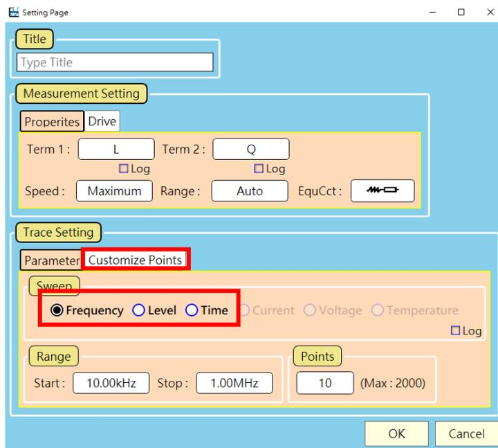
圖 36 Sweep 可以選擇 Frequency / Level / Time , Points 設定為 10 個
