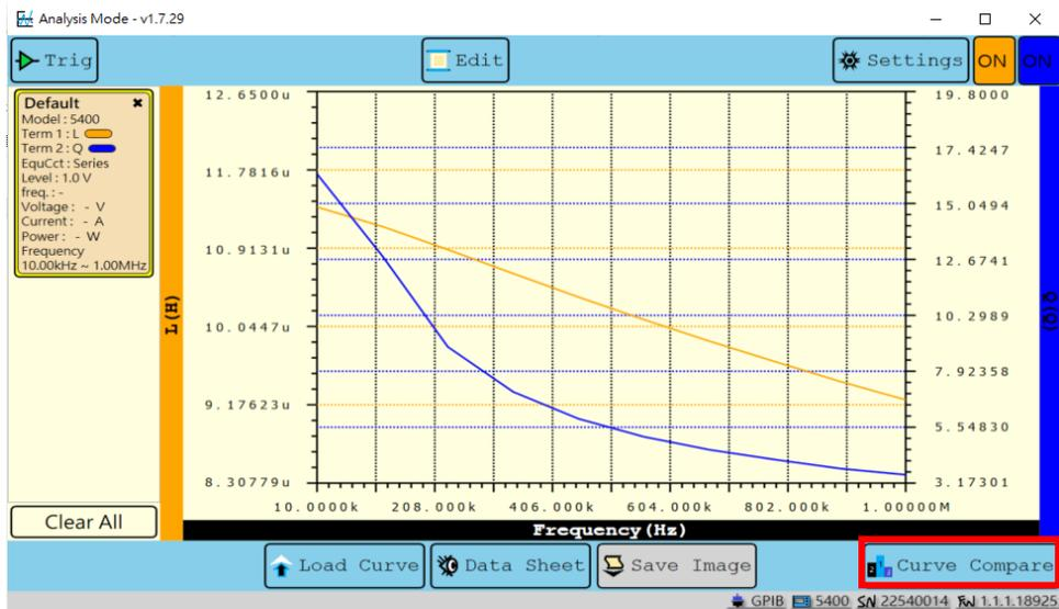
圖 43 如果有多個 Testing Result , 可選[Curve Compare]來比較結果
